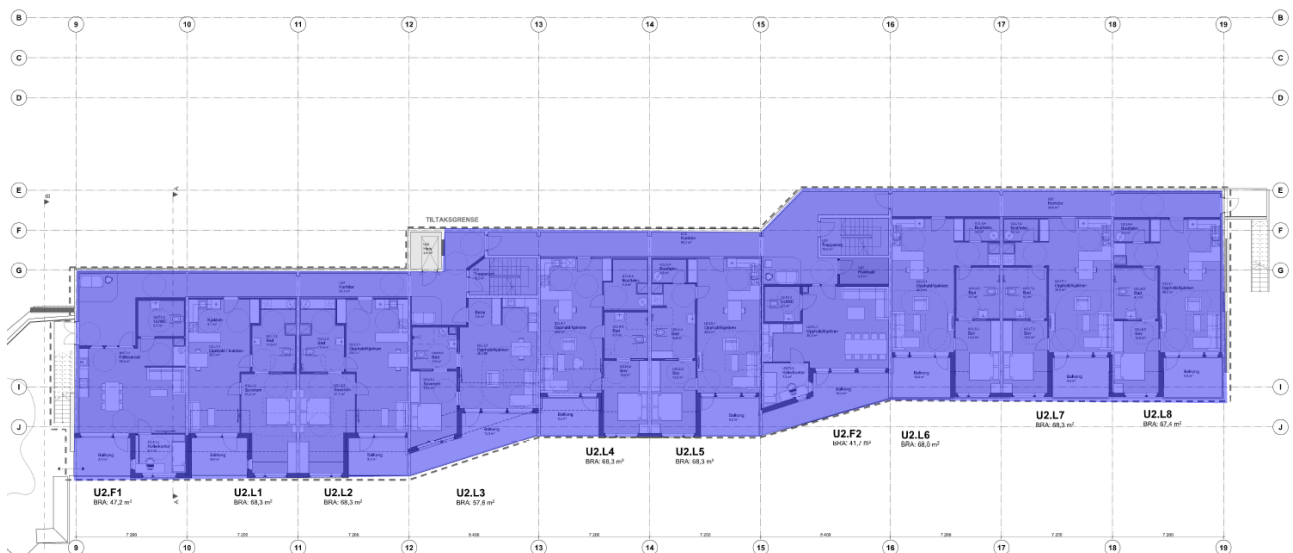
Figur 2. Forslag til sprinklerdekning i U2
